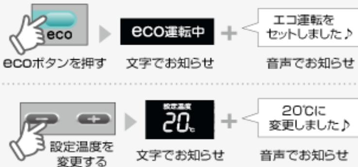
ボタンの操作に対して、文字表示と音声で応答するので、操作の結果を目と耳で確認できます。例えば、「eco」ボタンを押すと、「eco運転中」の文字が点灯し、同時に「エコ運転をセットしました」という音声でお知らせします。
